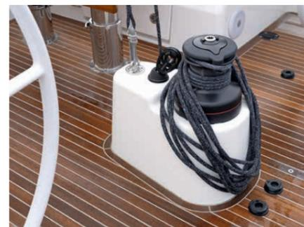
Wenig Schot, gutes Handling. Die zentrale Großschotführung funktioniert bestens
