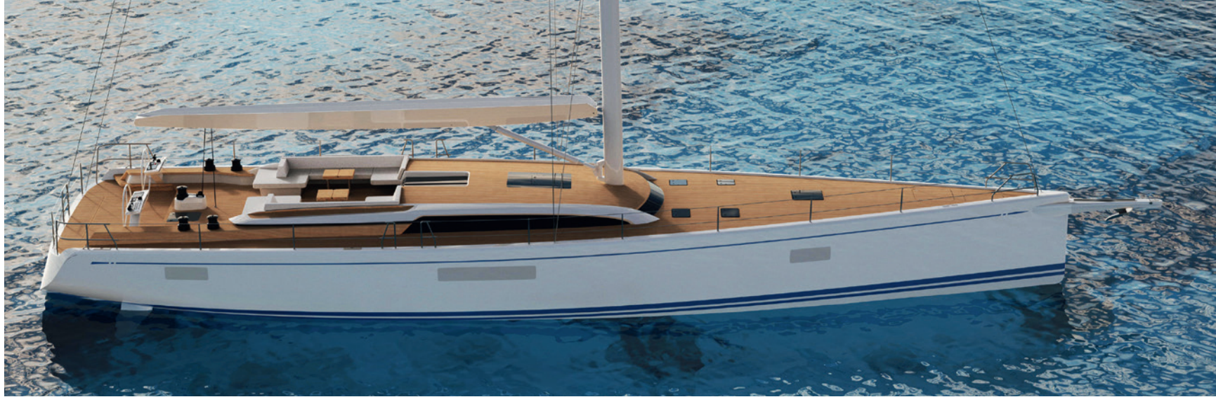
Swan 80: moderner Riss mit 24 Metern und fast 43 Tonnen. Am Mast setzt die Crew ein 200-Quadratmeter-Groß, die Fock misst 174 Quadratmeter.
