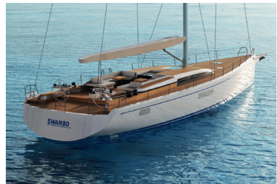
Leichtes Handling: Die Winschen der Slup sind gut erreichbar um die beiden Steuerräder platziert.
