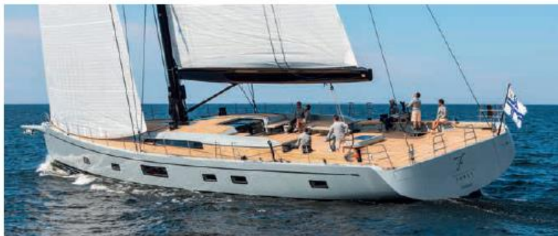
„Fancy“: Die erste Swan 108 in Stahlgrau und mit 648 Quadratmeter Segel am Wind. Germán Frers konstruierte, Lucio Micheletti gestaltete.
