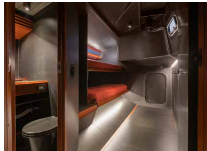
Konsequenter Leichtbau: Nur ganz wenige Komponenten des Interiors sind bei Regatten nicht ausbaubar.
